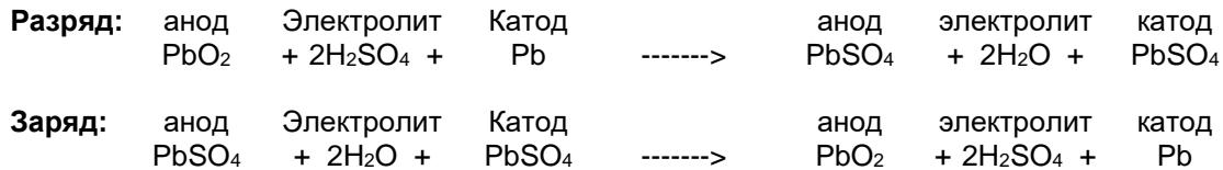
**При разряде** аккумулятора происходит двойная сульфатация, то есть на отрицательном и положительном электродах образуется сульфат свинца, который оседает на электродах в твёрдом виде. Так как часть серной кислоты расходуется на образование сульфата свинца и воды, то удельный вес электролита постепенно уменьшается.
